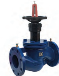
DRV-0201 Statik Balans Vanası Static Balance Valve Basınç Sınıfı / Pressure Rating: PN16 Gövde / Body: Dökme Demir / Cast Iron Klape / Disk: Paslanmaz Çelik-EPDM kaplı Stainless Steel / EPDM Coated Conta / Gasket: EPDM Flanşlı / Flanged Ölçü / Size: DN50-DN300
