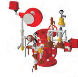
Unival Baskın Alarm Vanası Deluge Alarm Valve Basınç Sınıfı / Pressure Rating: 175 psi Gövde / Body: Sfero Döküm / Ductile Iron Klape / Disc: Bronz / Bronze - Elektrik Aktivasyonu / Electric Activated Flanşlı-Yivli / Flanged-Grooved Ölçü / Size: DN100-DN150
