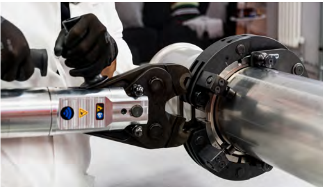
Şekil 34 - Pres montaj aşaması 1
