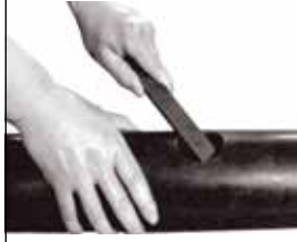
2. Çapakları temizleyin Remove burrs
