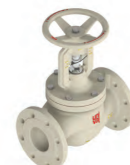
UGV-0301 Glob Vana Globe Valve Basınç Sınıfı / Pressure Rating: PN16 Gövde / Body: Sfero Döküm / Ductile Iron Kapak / Bonnet: Sfero Döküm / Ductile Iron Klape / Seat: Paslanmaz Çelik / Stainless Steel Salmastra / Packing: Grafit / Graphite Flanşlı / Flanged Ölçü / Size: DN15-DN250
