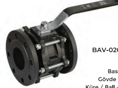
Bav-0201 Tam Geçişli Küresel Vana Full Port Ball Valve Basınç Sınıfı / Pressure Rating: PN10 / PN16 Gövde / Body: Dökme Demir / Cast Iron Küre / Ball : Paslanmaz Çelik / Stainless Steel Conta / Gasket: PTFE 2 Parçalı Flanşlı / 2 Pcs Flanged Ölçü / Size: DN15-DN300
