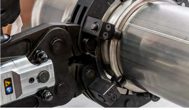
Şekil 35 - Pres montaj aşaması 2
