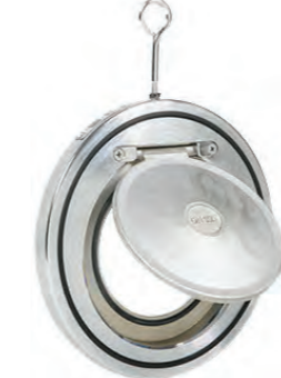
CHE-1001 Disk Tipi Çek Vana Disc Check Valve Basınç Sınıfı / Pressure Rating: PN16 Gövde / Body: Pirinç / Brass Disk / Disc: Paslanmaz Çelik / Stainless Steel Yay / Spring: Paslanmaz Çelik / Stainless Steel Water Tip / Wafer Type Ölçü / Size: DN15-DN100
