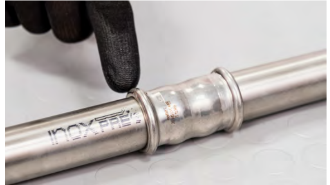
Şekil 33 - Pres bağlantısının kontrol edilmesi
