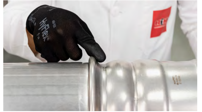
Şekil 36 - Büyük ebatlı preslemenin görsel kontrolü
