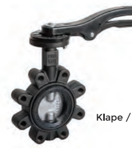
Wafer Kelebek Vana Wafer Butterfly Valve Basınç Sınıfı / Pressure Rating: PN16 Gövde / Body: Dökme Demir / Cast Iron Klape / Disc: Nikel Kaplı Sfero Döküm / Nickel Plated Ductile Iron Paslanmaz Çelik / Stainless Steel Conta / Gasket: EPDM El kumandalı / Hand Lever: DN40-DN200 Dişli kutulu / Gear Box: DN250-DN300 Ölçü / Size: DN40-DN200
