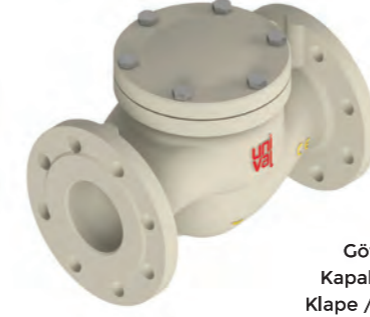
CHE-0301 Yaylı Çek Vana Lift Type Check Valve Basınç Sınıfı / Pressure Rating: PN16 Gövde / Body: Sfero Döküm / Ductile Iron Kapak / Bonnet: Sfero Döküm / Ductile Iron Klape / Seat: Paslanmaz Çelik / Stainless Steel Flanşlı / Flanged Ölçü / Size: DN15-DN200
